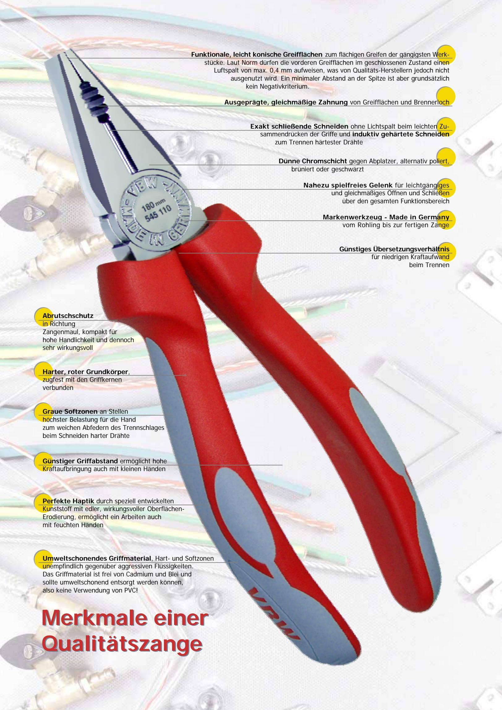
**Funktionale, leicht konische Greifflächen** zum flächigen Greifen der gängigsten Werkstücke. Laut Norm dürfen die vorderen Greifflächen im geschlossenen Zustand einen Luftspalt von max. 0,4 mm aufweisen, was von Qualitäts-Herstellern jedoch nicht ausgenutzt wird. Ein minimaler Abstand an der Spitze ist aber grundsätzlich kein Negativkriterium.
